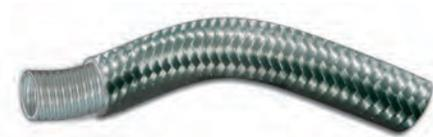
Las mangueras de acero inoxidable pueden utilizarse prácticamente sin limitación en el rango de -190°C hasta máx. +550°C para medios líquidos y gaseosos en todas las industrias, y son completamente resistentes a la difusión; no aptas para cloruros, bromuros y otros halógenos.
