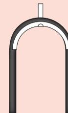
Para la instalación en arco, se debe seleccionar una longitud de manguera tal que la curva deseada pueda formarse más allá de una longitud de  $\approx 1.5 d_0$ ; también puede ser necesaria una protección contra acodamientos (ej. Un casquillo rígido).
