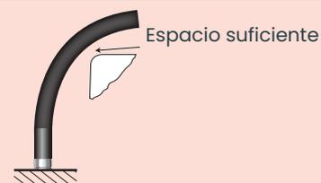
Evitar colocar soportes de manguera en puntos que impidan el movimiento libre natural y los cambios de longitud de la manguera de calefacción.
