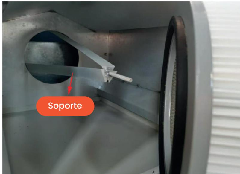
Deje que el tornillo del soporte pase a través del agujero en el otro lado del cartucho, y vuelva a colocar la junta.
