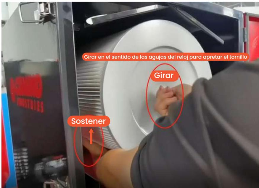
Aquí se muestra la imagen de la tapa frontal abierta, en la que se puede ver cómo debería verse una buena instalación del filtro de cartucho: Se puede observar que el anillo de sellado de goma está bien ajustado a la pared interior de la caja.
