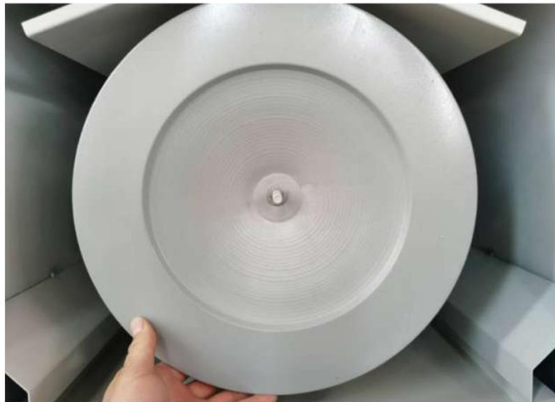
Use su mano para sostener y levantar la posición central del filtro de cartucho, de modo que el anillo de sellado de goma del filtro quede bien ajustado a la pared interior de la caja (para sellar el filtro durante la instalación).
