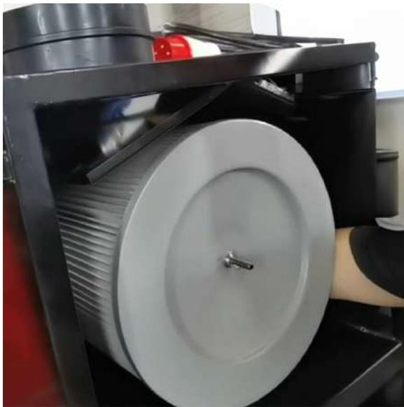
Después de apretar el tornillo, puede colocar una mano dentro para tocar el lado interior del cartucho del filtro, para ver si hay espacios y para verificar si el anillo de sellado de goma se ha fijado firmemente a la pared interior de la carcasa de la máquina o no.
