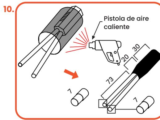
Coloque la funda termorretráctil TRDP6-B como indica y selle con pistola de aire caliente. Pele a 7mm el aislamiento de los cables.
