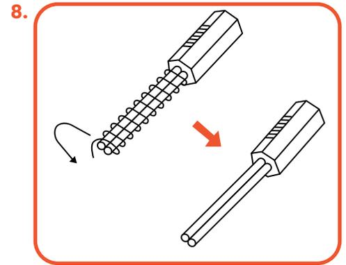
Corte y remueva el hilo resistivo hasta el borde del aislamiento. No dañe el aislamiento de los cables
