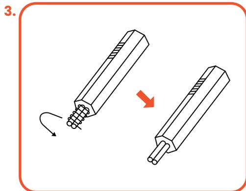
Corte y retire el hilo resistivo hasta el borde del aislamiento. No dañe el aislamiento de los cables.
