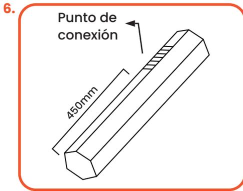
Corte el cable calefactor a 450mm como máximo del punto de conexión
