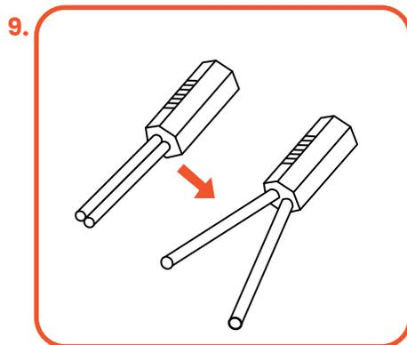
Divida los dos cables, separando el aislamiento en la parte central.
