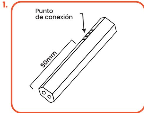
Corte el cable calefactor a 50mm del punto de conexión
