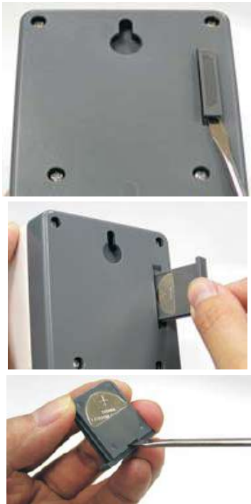
Fig. 06 – Instrucciones para cambiar la batería del Timer TM-6331
