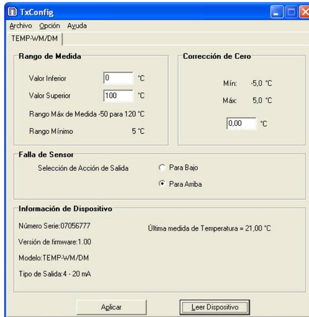
Figura 8 – Pantalla principal del software TxConfig
