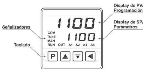
Figura 7 - Identificación de las partes del panel frontal
