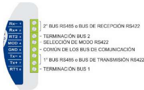
Figura 6 – Conexiones del dispositivo
