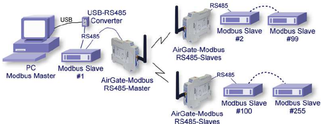
Figura 5 – Segmentos inalámbricos en cualquier punto de una red Modbus
