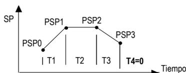
Fig. 4 - Ejemplo de programa con solo 3 segmentos
