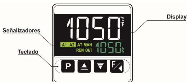
Fig. 02 - Identificación de las partes del panel frontal
