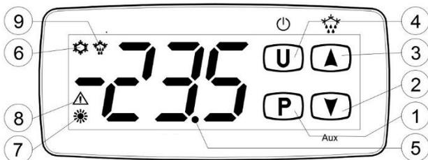
**1 - Tecla P:** Pulsando y soltando rápidamente se accede al cambio de Set Point. Pulsando durante 5 Segundos se accede a la modalidad de programación de parámetros. En modalidad de programación se utiliza para acceder y editar los parámetros y para confirmar el valor deseado.
