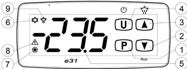
**1 - Tecla P:** Pulsando y soltando rápidamente se accede al cambio de Set Point.
