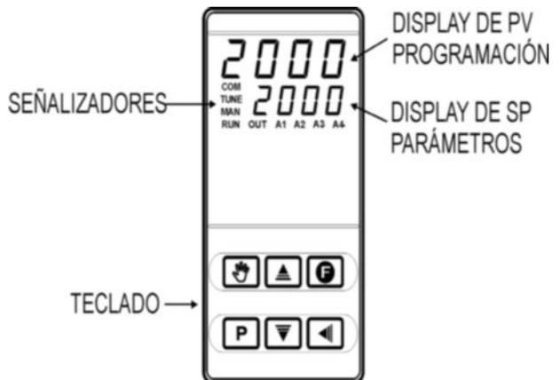
**Display de PV / Programaci n:** Presenta el valor actual de la PV (Process Variable). Cuando en el modo de operaci n o programaci n, muestra el mnemotcnico del parmetro que est siendo presentado.
