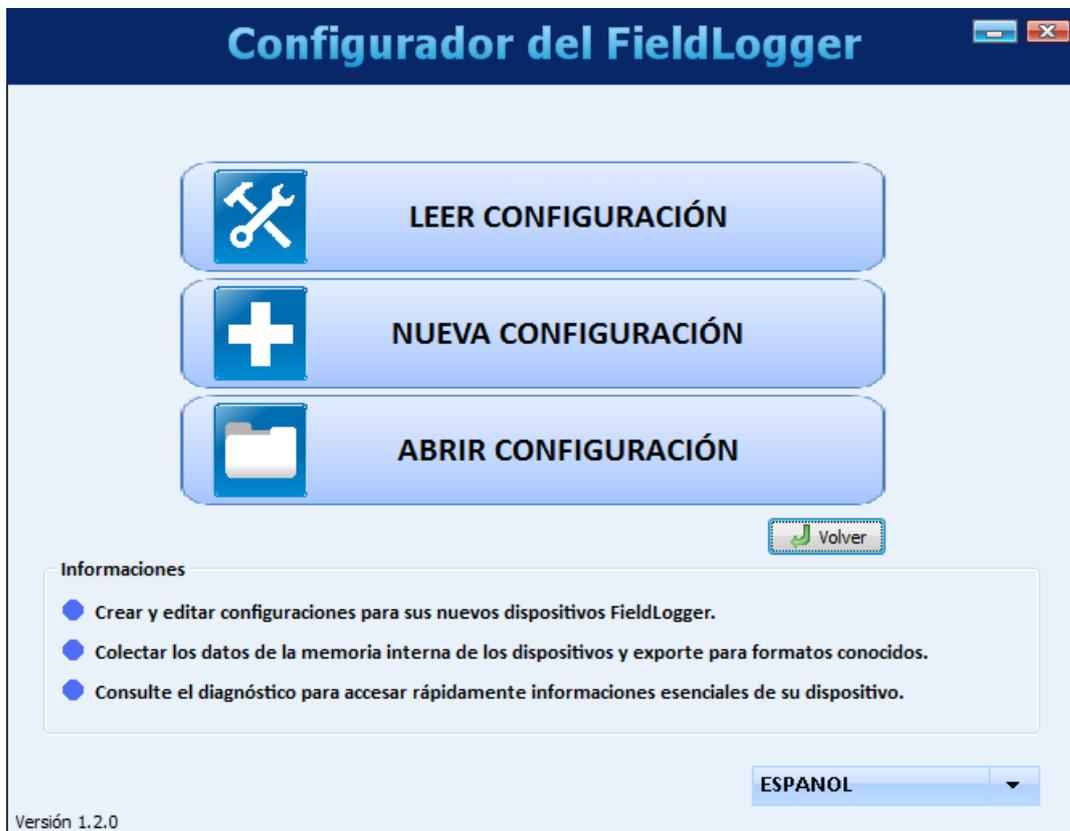
Si la opción escogida fue para crear una nueva configuración, será necesario indicar un archivo en donde esta configuración será guardada. A partir de la versión de software 1.40, también se debe indicar el modelo del FieldLogger que se va a configurar (el voltaje – normal o 24 V – no tiene importancia en este caso):
