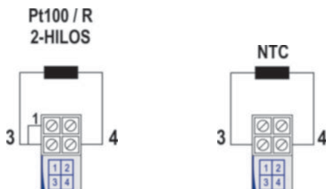
Fig. 6 ▯ Conexiones eléctricas del transmisor (Pt100 2 hilos / NTC)
