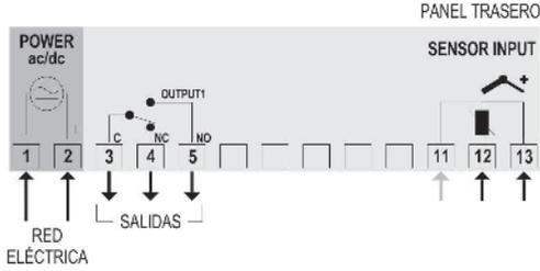
Fig. 02 Conexiones mostradas en la etiqueta del controlador
