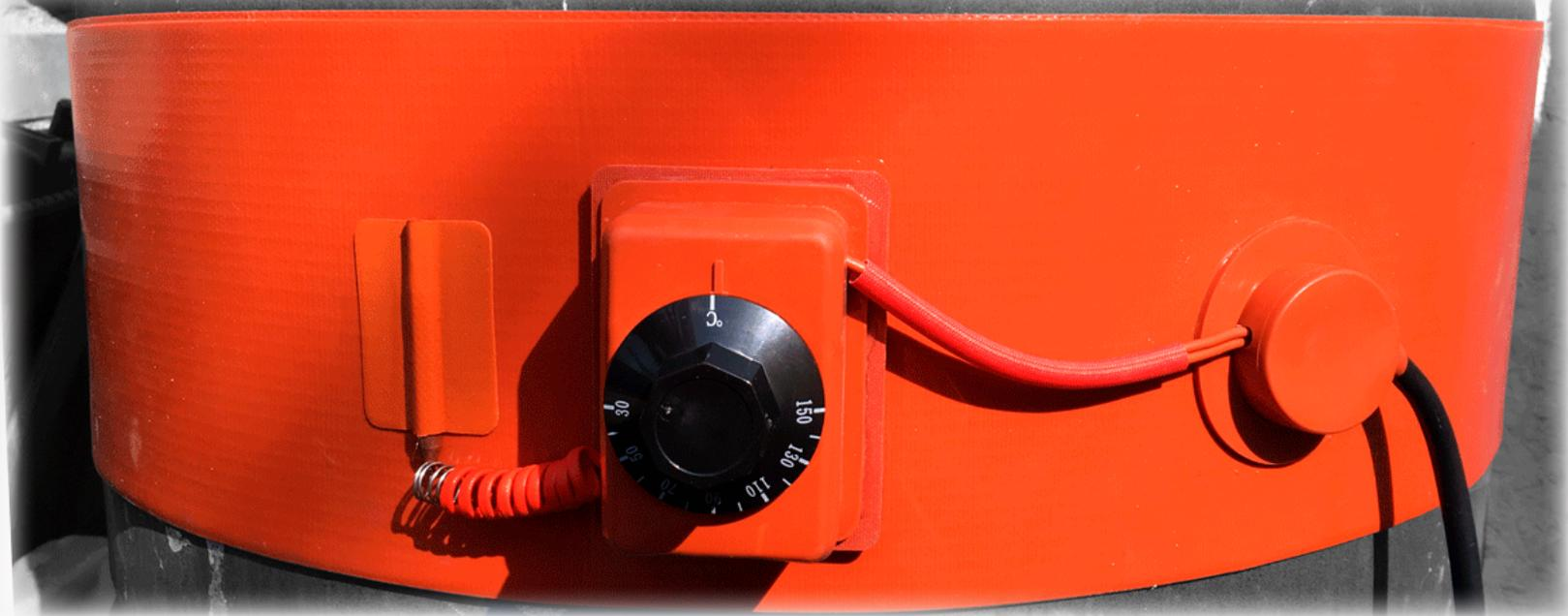
Las fajas calefactoras son utilizadas principalmente para mantener temperatura de fluidos dentro de tambores (hasta 200L), están fabricadas íntegramente en tela siliconada, poseen termostato para asegurar un calentamiento continuo y parejo.
